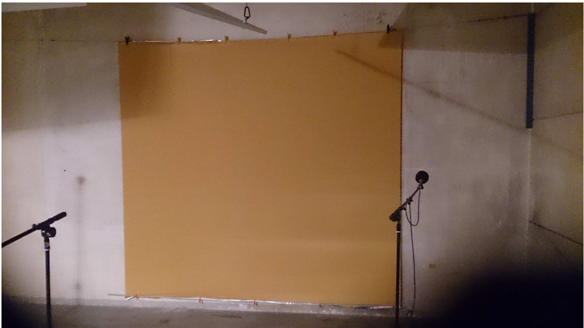
Abbildung 1: Befestigung der Plisseestoffe bei den Messungen im Hallraum am 16.11.2015
